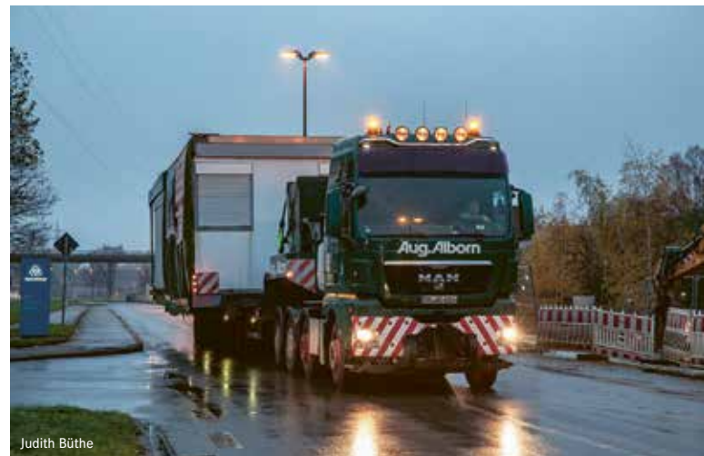
Drei Stunden benötigten zwei Tieflader mit je einer Haushälfte für die fünfzehn Kilometer von Kleinholthausen bis zum Hoesch-Museum.
